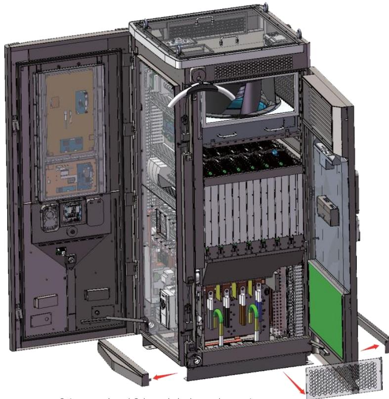
Seitenwand und Schutzabdeckung demontieren
