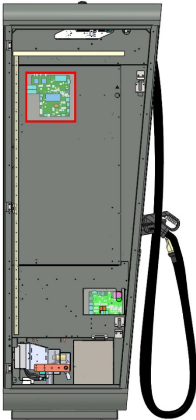
Abbildung 30: Position des CTRL_COM im Hypercharger
