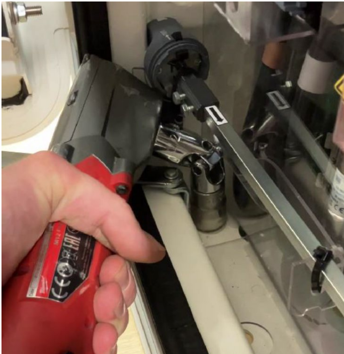
Abbildung 43: Winkeladapter-Einsatz zum Lösen der Palettenschrauben
