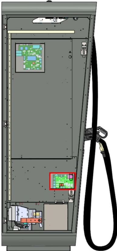
Abbildung 33: Position des CTRL_EXT im Hypercharger
